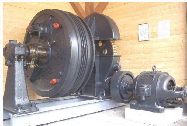
Aufzugsmaschine an seinem jetzigen Standort mit geöffnetem Getriebe
