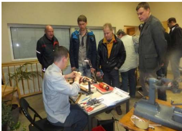
Manueller Einbau der Wicklung in einen Gleichstromanker während der Museumsnacht 2014
